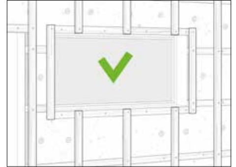
Bei der Montage von Vertikallatten ist nochmals zu prüfen, ob die Hinterlüftung überall ungehindert ist.
