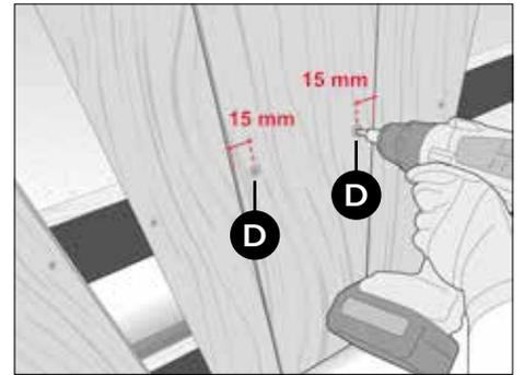
Positionieren Sie die Deckelpaneele mit 30 mm Überlappung zu den hinteren Paneelen. Die mit 7 mm vorgebohrten Deckelpaneele mit farbigen Cedral Schrauben (D) mit einem Randabstand von 15 mm befestigen. Die Schraube muss beide Paneele durchdringen und 25 mm in das Holz eindringen.
