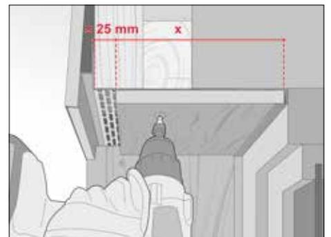
Messen, schneiden und montieren Sie nun ein Fensteranschlussprofil (E) mit dem Kleber und dem Schaumstoffstreifen (G) an der Oberseite der Fensterleibung, wie im Bild dargestellt.
