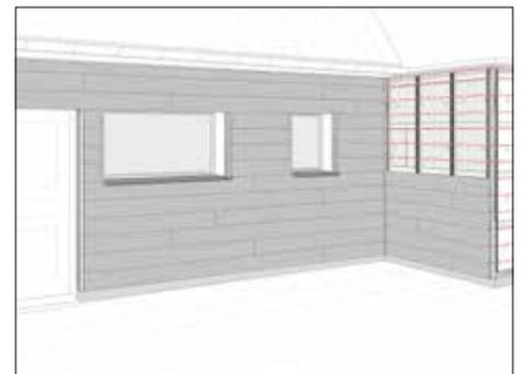
Schneiden Sie die Oberseite des letzten Panels in Längsrichtung mit der Säge auf die richtige Höhe zu, wobei Sie darauf achten müssen, dass oben an der Fassade ein Mindestabstand von 10 mm für die Hinterlüftung eingehalten wird.
