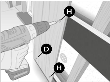
Befestigen Sie die hinteren Paneele zweimal an jeder Tragplatte mit mindestens 20 mm Abstand zu den Paneelkanten.
