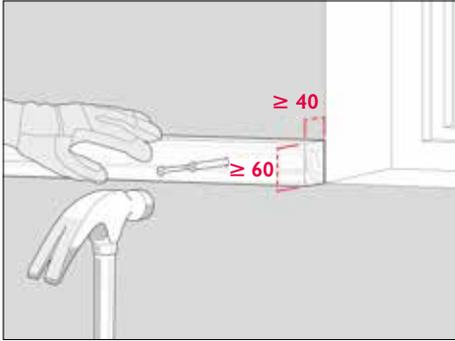
Befestigen Sie die Lattung 40 x 60 mm mit dem entsprechenden Befestigungsmittel an den Untergrund.
