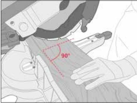
Schneiden Sie das Panel passend ab. Vergewissern Sie sich, dass es absolut rechtwinklig ist. Tragen Sie beim Schneiden immer Schutzkleidung.
