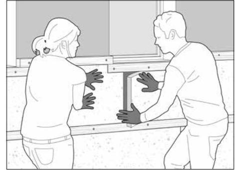
Verlegen Sie die Dämmung versetzt zwischen den waagerechten Holzlatten und bündig mit der Vorderkante des Holzes. Vermeiden Sie eventuelle Lücken.
