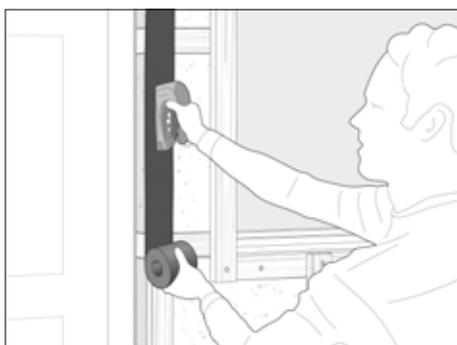
Schützen Sie nun alle Traglatten von oben nach unten mit einem EPDM Band (K). An den Außenecken und Fensterleibungen führen Sie das EPDM Band (K) um die Ecken herum.
