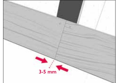
Nächstes Paneel montieren. Legen Sie das nächste Paneel neben das vorherige Paneel und immer auf eine darunter liegende Traglatte. Dabei wird eine Fuge von 3-5 mm empfohlen.
