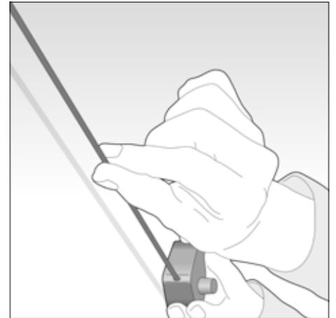
Für das Festlegen des Sockelpunktes messen Sie mindestens 15 cm über dem höchsten Punkt des Bodens und markieren Sie ihn an der Wand. Zeichnen Sie eine gerade Grundlinie umlaufend an die Fassade, damit Ihr Sockel überall auf einer Höhe liegt. Ein Laser ist hier hilfreich.
