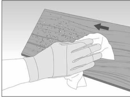
Nach dem Schneiden den Schneidstaub mit einem Mikrofasertuch von der Oberfläche und der Panelkante entfernen.
