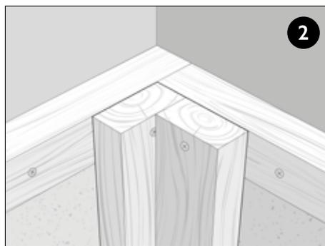
Achten Sie darauf, dass die Holzlatten in den Innenecken breit genug sind (ggf. Doppellatte anbringen), da sie die später einzubauenden Profile stützen.
