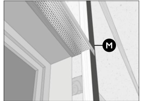
Um die Fassade frei von Kleintieren zu halten, montieren Sie die Lüftungsprofile (M) unten an der Fassade und über den Fenstern und Türen. Achten Sie darauf, dass alle Spalte größer als 15 mm mit den Lüftungsprofilen geschlossen werden.
