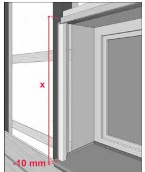
Mit der eingebauten Fensterbank können Sie nun die Länge des Leibungsprofils bestimmen und dabei darauf achten, dass ein Spalt (10 mm) zur Fensterbank verbleibt.
