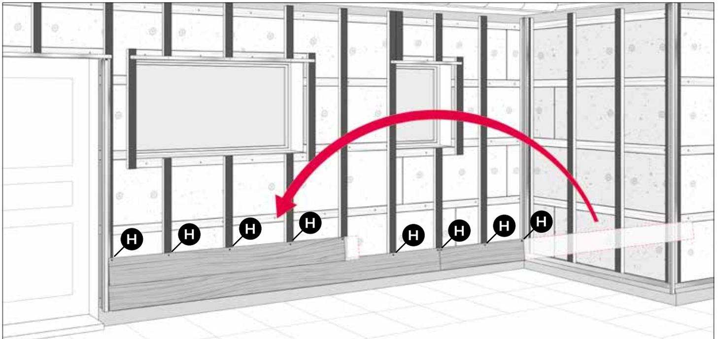
Minimieren Sie Reste. Schneiden Sie den restlichen Teil des Panels auf Länge. Benutzen Sie den verbleibenden Teil des Panels, um mit der nächsten Reihe zu beginnen. Achten Sie darauf, dass das Paneelende immer mittig auf einer Holzlattung liegt.
