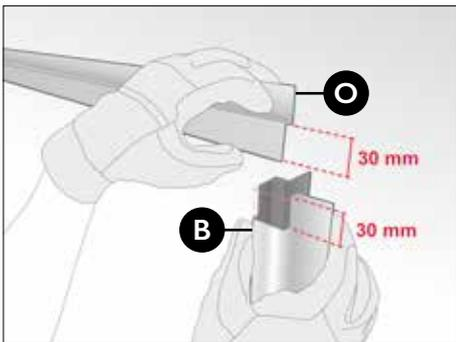
Schneiden Sie das Leibungsprofil (B) zu (Unterkante Sockel bis Oberkante Sturz), um einen sauberen Anschluss zu gewährleisten. Klinken Sie das Leibungsprofil (B) wie im Bild dargestellt aus.
