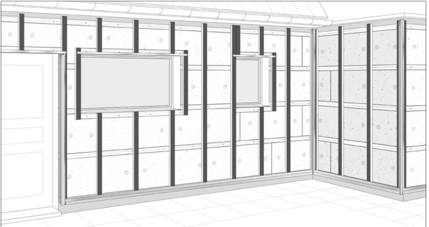
Vor der Montage der Cedral Lap Paneele ist zu prüfen, ob das Starterprofil (O) waagrecht ist und überall auf gleicher Höhe beginnt. Überprüfen Sie auch, ob die Hinterlüftung ungehindert bleibt.
