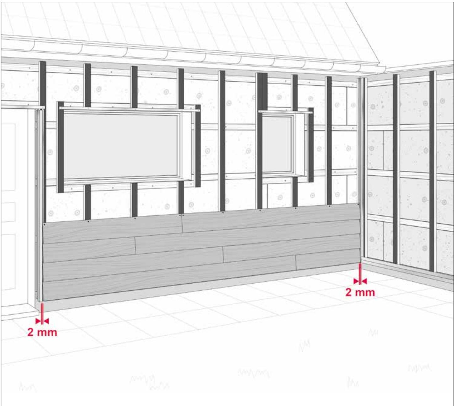
Arbeiten Sie von unten nach oben, montieren Sie die Paneele reihenweise übereinander und schrauben Sie das Panel an jeder Traglatte fest. Montieren Sie weiter, bis Sie ein Fenster erreichen. Dann verfahren Sie wie auf den folgenden Seiten beschrieben.
