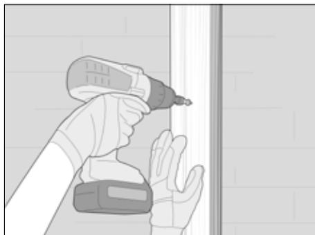
Wenn größere Dämmstoffdicken benötigt werden oder die Wand sehr uneben ist, können mehrere Lagen Lattung oder eine Mischkonstruktion aus Metallwandhaltern und Holzunterkonstruktion verwendet werden. Kontaktieren Sie Ihren Händler für weitere Details.
