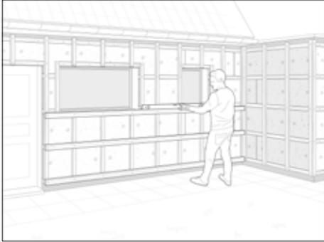
Montieren Sie eine weitere Ebene horizontaler Holzplatten auf die bereits montierten vertikalen Tragplatten.
