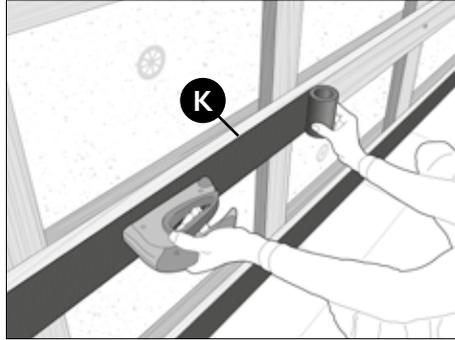
Auf die horizontalen Tragplatten werden EPDM Bänder (K) aufgetragen.
