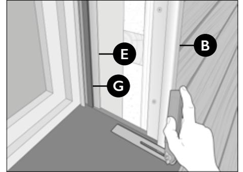
Nach dem Zuschneiden des Leibungsprofils (B) wird ein Polyurethan-Kleber oder ein Schaumstoffstreifen (G) auf die Vorderseite des Fensteranschlussprofils (E) aufgetragen. Auf der Innenseite des Fensteranschlussprofils (E) wird ein Schaumstoffstreifen (G) angebracht. Das Fensteranschlussprofil (E) wird fluchtgerecht am Leibungsprofil (B) ausgerichtet, am Fensterrahmen angedrückt und seitlich verschraubt.
