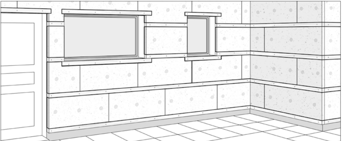
Befestigen Sie die Dämmung mit Dämmstoffhaltern (5 Stück pro Quadratmeter). Achten Sie darauf, dass die Dämmung fest gegen die Wand gedrückt wird und sich keine Spalten bilden.
