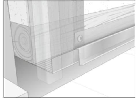
Das Starterprofil (O) wird über dem Lüftungsprofil (M) und neben dem Eckprofil/Leibungsprofil montiert.
