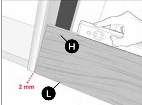
Positionieren Sie das erste Paneel auf dem Starterprofil (O), wobei Sie einen Abstand von 2 mm seitlich zum Außeneck- oder Leibungsprofil einhalten.
