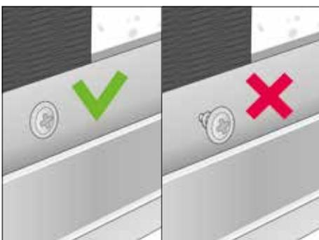
Befestigen Sie das Profil mit den Cedral Lap Schrauben (H). Achten Sie darauf, dass alle Schrauben an der Profilloberfläche anliegen.
