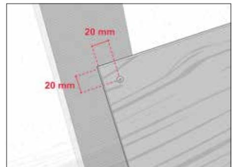
Befestigen Sie die Schrauben 20 mm von der Paneeelseite und -oberkante entfernt. Schrauben sollen nur anliegen, nicht bündig eingedreht werden.
