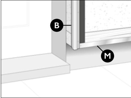
Achten Sie darauf, dass die Unterseite der Eckprofile oder Leibungsprofile (B) unten bündig mit dem Lüftungsprofil (M) abschließt.
