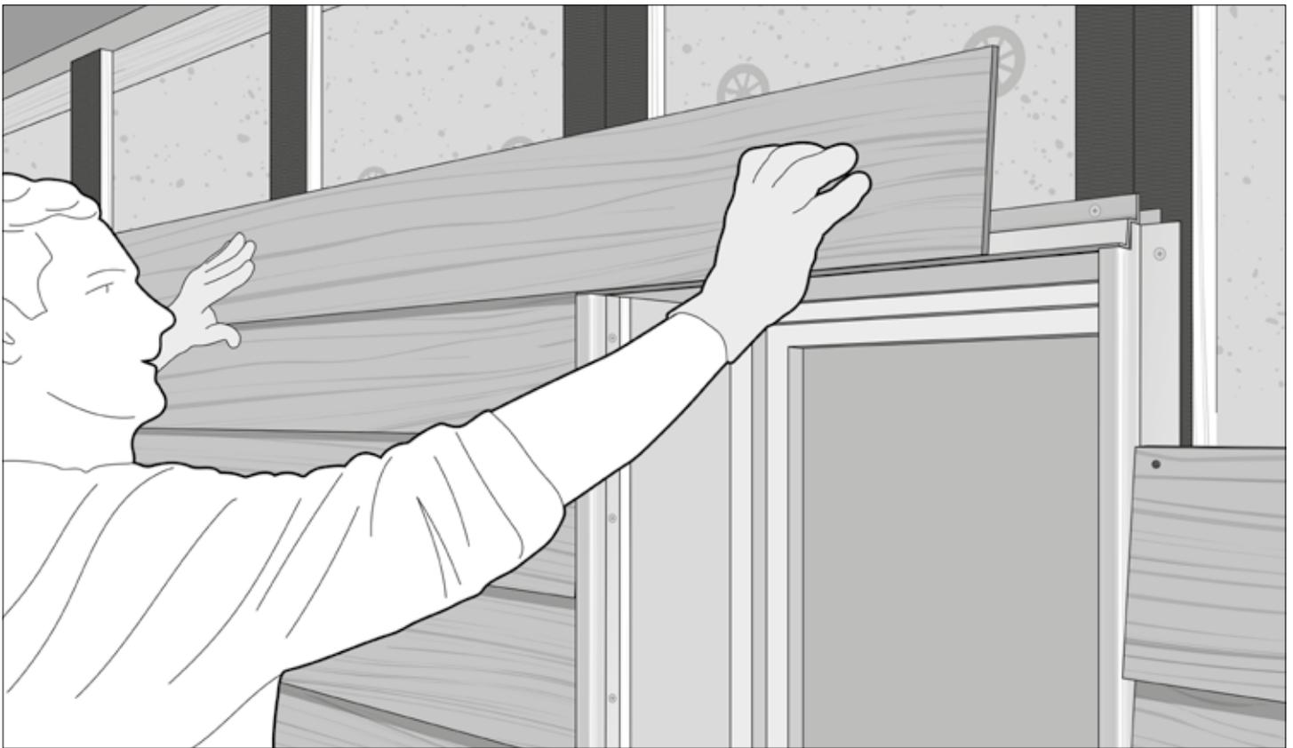
Arbeiten Sie sich neben dem Fenster hoch. Wenn Sie das erste Panel über dem Fenster erreicht haben, zeichnen Sie die Kontur des Fensters auf die Rückseite des Panels und schneiden Sie diese mit der Stichsäge aus. Vergewissern Sie sich, dass das Panel am oberen Rand des Fensters mit den anderen Paneelen im Reihenverlauf übereinstimmt und befestigen Sie dieses dann mit einer Cedral Lap Schraube (H).
