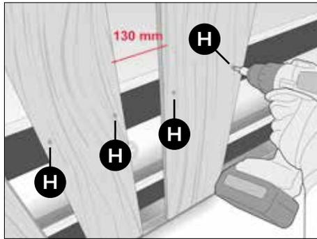
Die Paneele bis zum Ende mit Abstand von 130 mm montieren und mit Cedral Lap Schrauben (H) befestigen.
