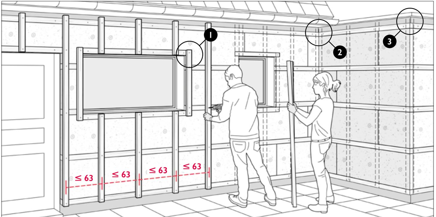
Befestigen Sie nun die vertikalen Holzlatten am Untergrund (z.B. an der horizontalen Unterkonstruktion), beginnend von den Außenecken nach innen.
