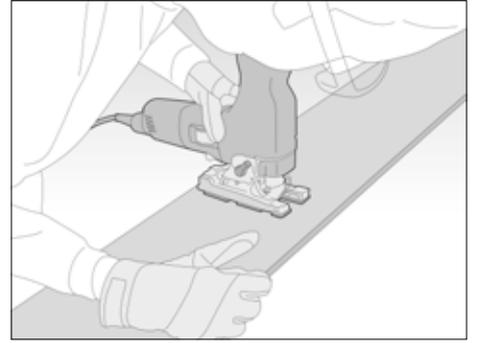
Wenn das letzte Paneel unter dem Fenster fertig gestellt ist, können Sie die Fensterbank anhalten und die Position der Fensterbank auf dem nächsten Paneel markieren. Drehen Sie das Paneel um und zeichnen Sie den Umriss der Fensterbank auf der Rückseite des Paneels nach. Zwischen der Fensterbank und dem Paneel ist ein Abstand von 10 mm für die Hinterlüftung vorzusehen.
